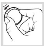
**Girar el selector hacia derecha o izquierda para salir del modo configuración.**
